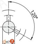
N新JIS键槽孔+螺孔
